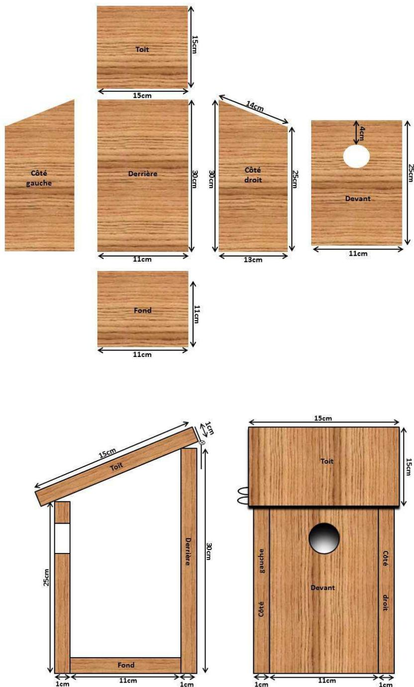
**Figure 86** : Modèle de nichoir pour Mésanges, Rougequeue à front blanc et Torcol fourmilier, le diamètre du trou d'entrée doit être de 28 ou 34 mm selon les espèces.
