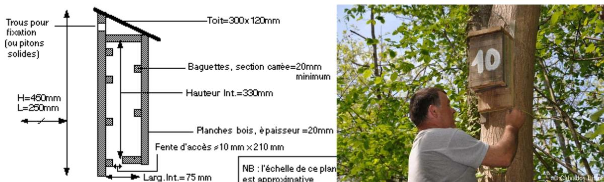
Figure 82 : Plan de gîte et exemple de pose sur arbre.
